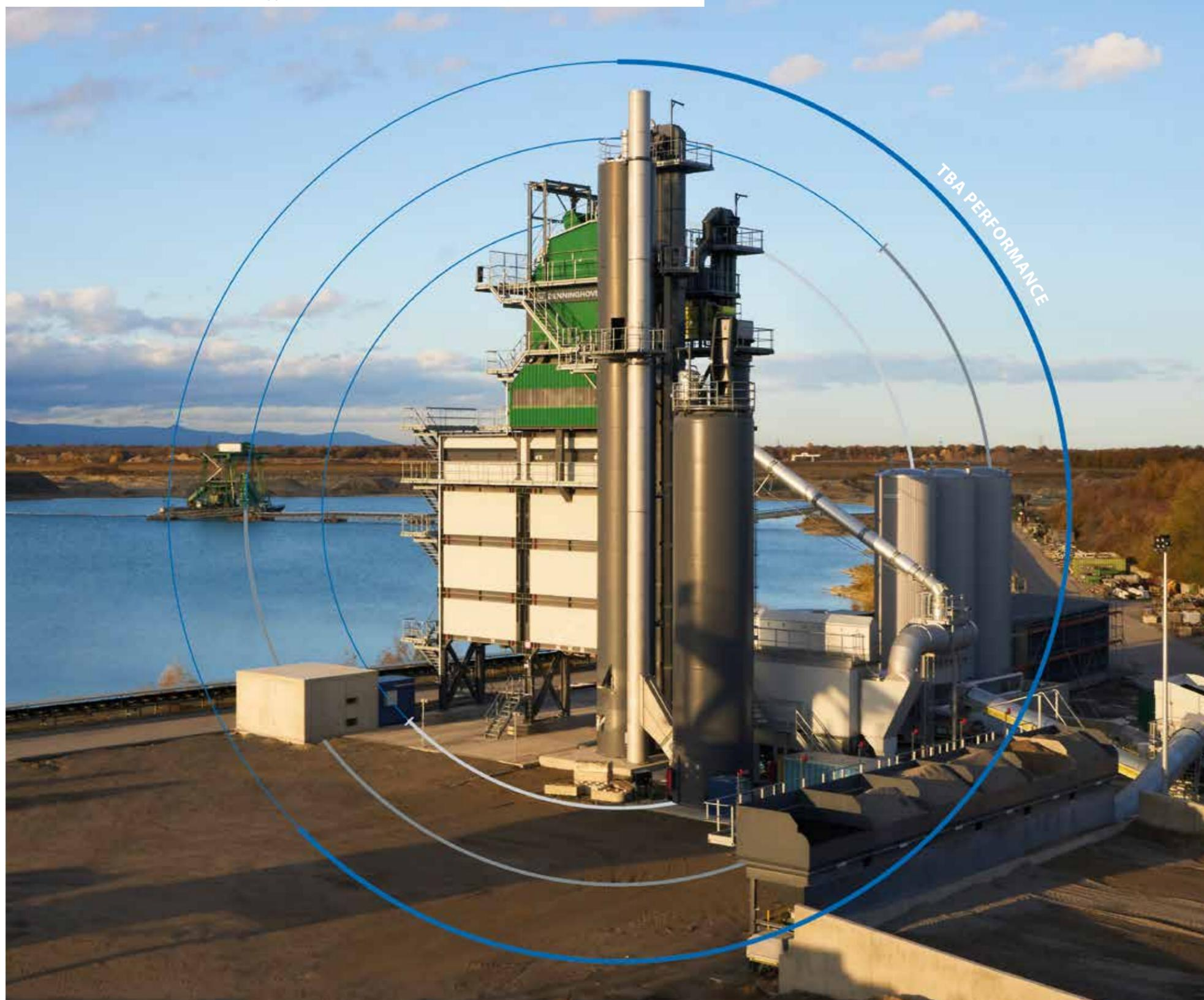
Компактные заводы типа TVA поражают производительностью и надежностью в эксплуатации. При производительности смешивания до 320 т/ч оптимальное качество смеси гарантированно всегда.
