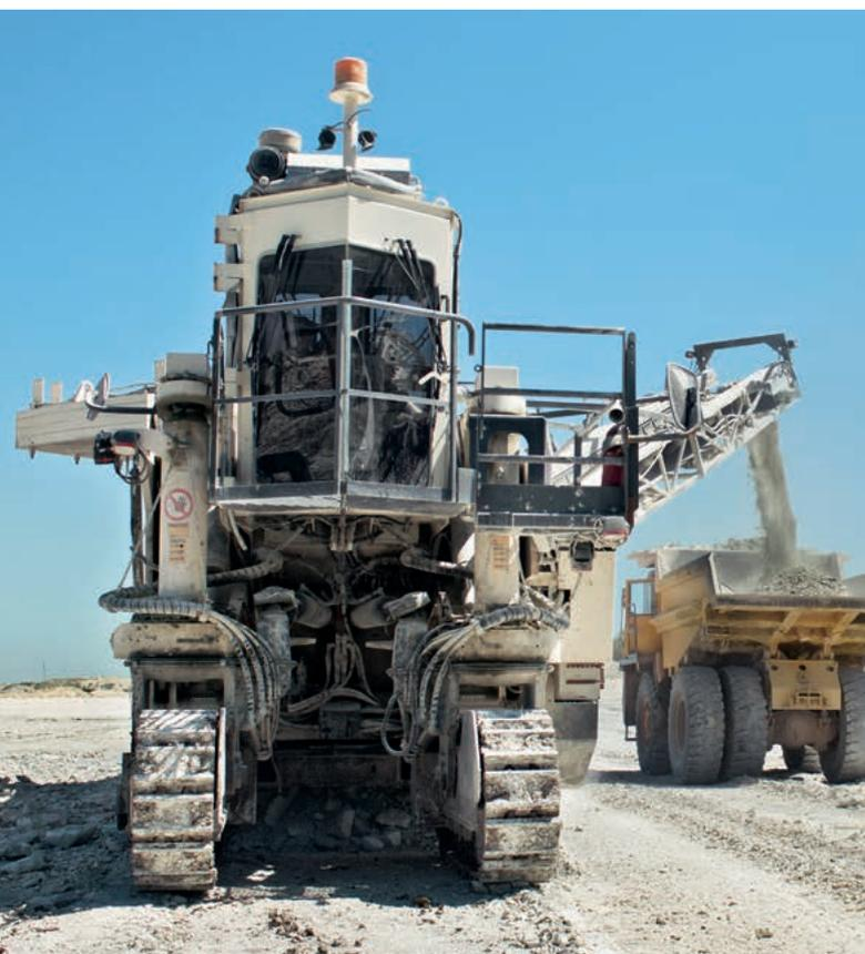
Рудник ЗАО «Кавказцемент», входящий в «Евроцемент групп» и расположенный вблизи Черного моря в России, является крупнейшим производителем цемента на Северном Кавказе. Селективная разработка известняковых месторождений, осуществляемая при помощи карьерных комбайнов WIRTGEN, обеспечивает стабильно высокую ежедневную выработку без бурения и взрывных работ.
